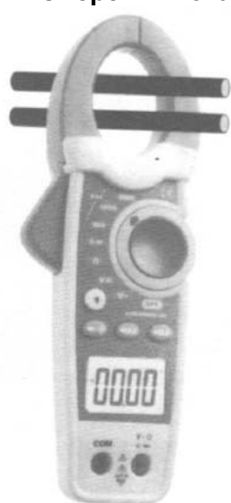
Неправильный способ измерения тока
